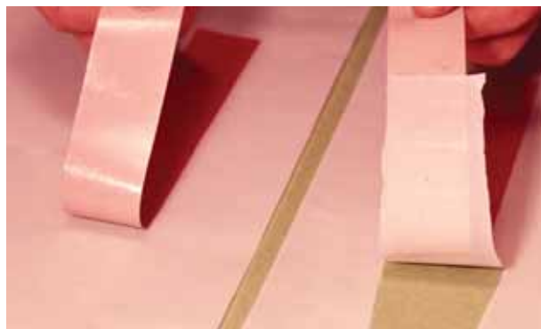
剥離紙用シリコーン処理した基材は容易に粘着剤を剥離させます。
